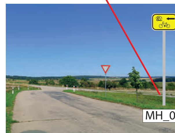
INSTALACE IS21b (MLYNÁŘSKÁ) NA NOVÝ SLOUPEK, V KOTEVNÍ PATCE POZEMEK: PARC. Č. 4223/1, K. Ú. MOHELNO (MĚSTYS MOHELNO)
